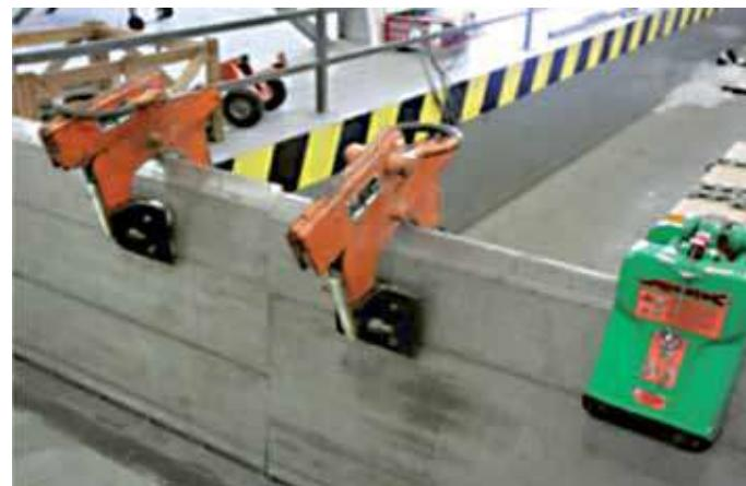
Для открытия упаковки или транспортировки отдельных плит, должен использоваться зажим типа «крокодил» или стандартный зажим (и тот и другой прорезиненый) как показано на картинке.
